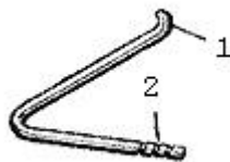
Рис. 53. Крючок: 1 – загиб на верхнем пере: 2 – надпилы на нижнем пере для крепления «подсучки».
