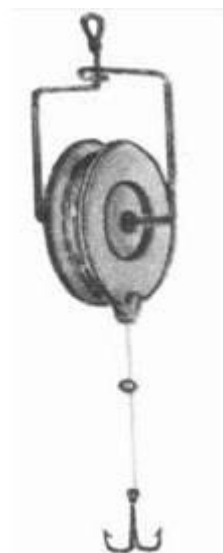
Рис. 7. Жерлица из бобины из-под лески.
