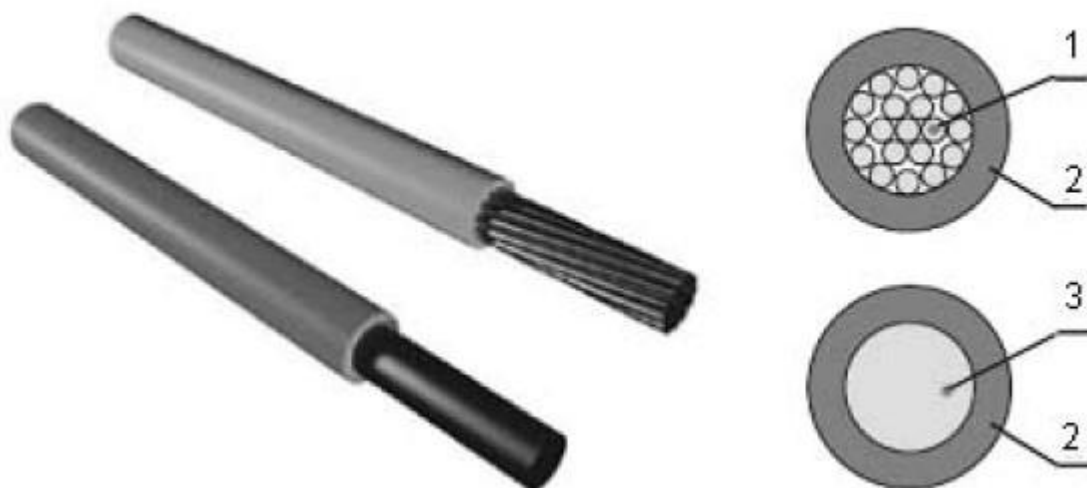
Рис. 6. Провода с многопроволочной (сверху) и однопроволочной токопроводящей жилой: 1 – многопроволочная жила; 2 – ПВХ-изоляция; 3 – однопроволочная жила.
